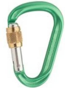
Klein, leicht und praktisch - der HMS MINI.MI Karabiner ist der leistungsstarke, aber deutlich kleinere Bruder des HMS RONDO. Der runde Querschnitt am oberen Schenkel verhindert eine durch Seilreibung verursachte Kantenbildung und unterstützt zudem eine flüssige Seilführung. Der HMS MINI.MI als Schraubkarabiner mit leichtläufiger und korrosionsbeständiger Messingrolle. Durch die spezielle Fräsung im Gewinde reinigt sich der Verschluss von selbst.
